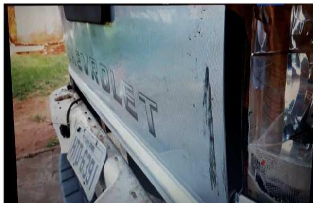
**FISSURA E PINTURA COMPROMETIDA NA TAMPA CAÇAMBA**
