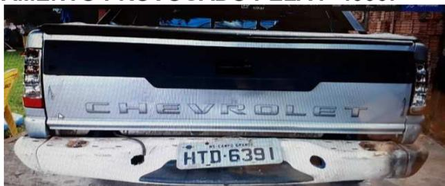
**DANOS NA TRASEIRA: LANTERNA ESQUERDA E DIREITA, PARACHOQUE, PLACA, EMPENAMENTO DA TAMPA CAÇAMBA**
