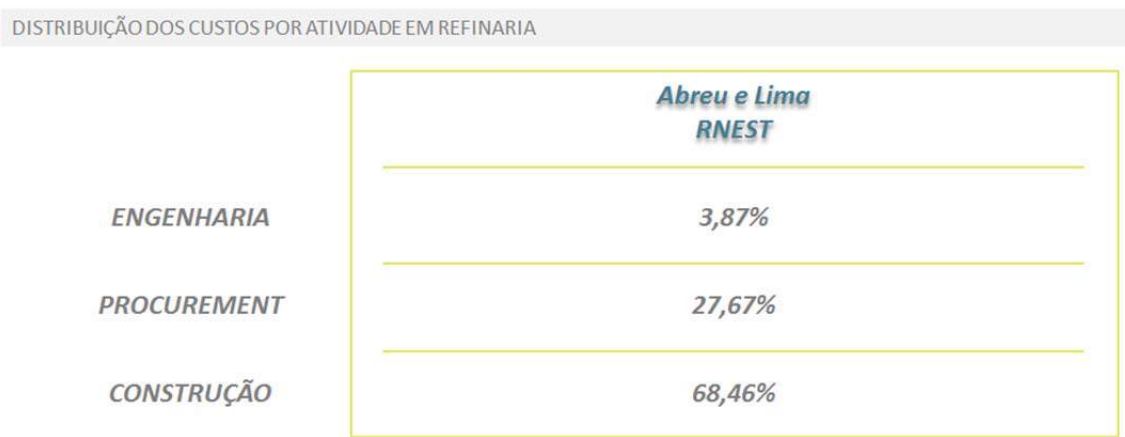
Figura 102: Exemplo de distribuição dos custos por atividade de EPC para construção das plataformas responsáveis por expandir o refino de petróleo no Brasil
