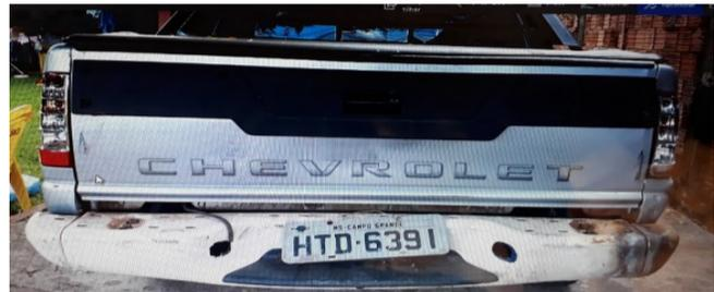
**DANOS NA TRASEIRA: LANTERNA ESQUERDA E DIREITA, PARACHOQUE, PLACA, EMPENAMENTO DA TAMPA CAÇAMBA**
