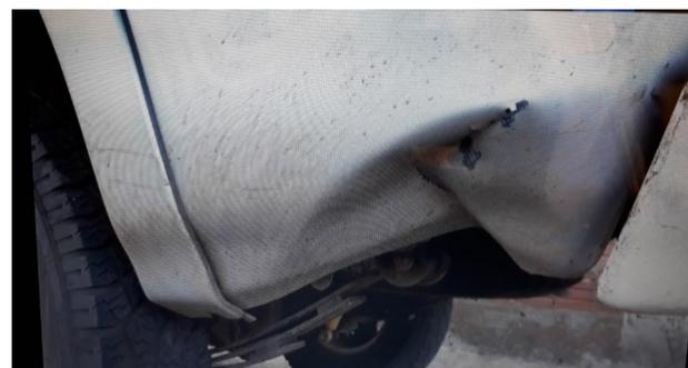
**AFUNDAMENTO, CORTE DA LATARIA E DANOS NA SUSPENSÃO E AMORTECEDORES DA LATERAL ESQUERDA INFERIOR**
