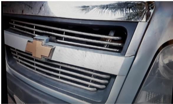
**FISSURA E AFUNDAMENTO NA GRADE FRONTAL E AMASSAMENTO NA LATERAL DIREITA DA LATARIA, DANOS NO FRISO ACIMA DA GRADE, DANOS NO PARACHOQUE DIANTEIRO, FARÓIS**
