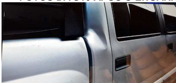
COM O VIOLENTO IMPACTO, A COLUNA DA S10 FOI DANIFICADA
