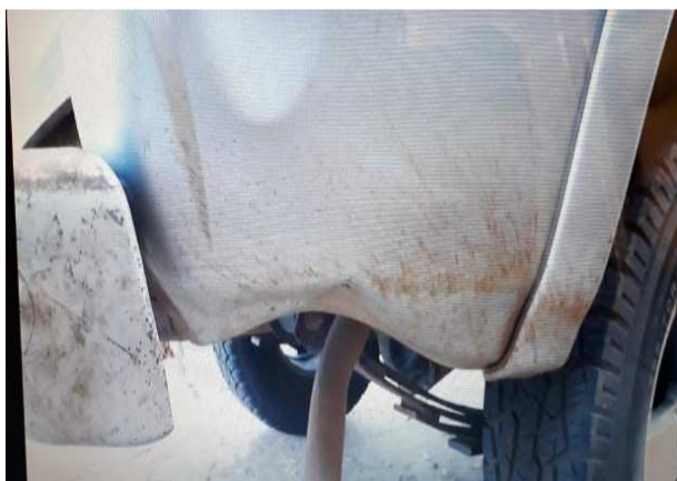
AMASSAMENTO DA PARTE INFERIOR DIREITA, ESCAPAMENTO, DANOS NA SUSPENSÃO
