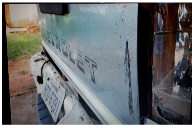
FISSURA E PINTURA COMPROMETIDA NA TAMPA CAÇAMBA
