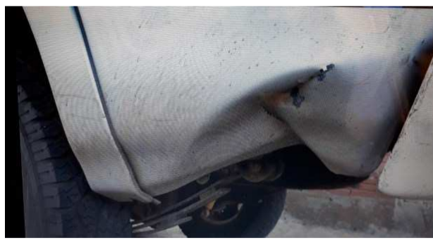
AFUNDAMENTO, CORTE DA LATARIA E DANOS NA SUSPENSÃO E AMORTECEDORES DA LATERAL ESQUERDA INFERIOR
